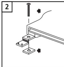
2 Coloque el empaque cuadrado en la parte inferior de la bisagra e inserte el tornillo por la parte superior del orificio de la bisagra.
