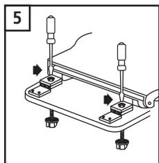
5 Con un destornillador plano apriete el tornillo hasta que ajuste con la cerámica sanitaria.
