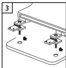
3 Coloque el asiento sobre la base del sanitario e inserte los tornillos en los orificios del sanitario.
