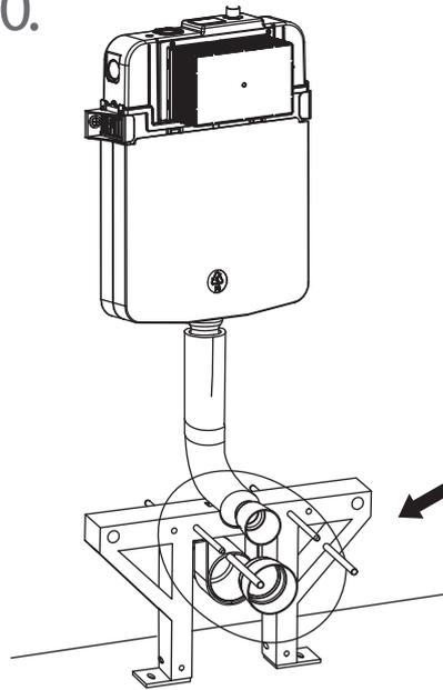
Colocar protecciones plásticas. Cubrir la tubería para evitar el ingreso de desechos del sistema.
