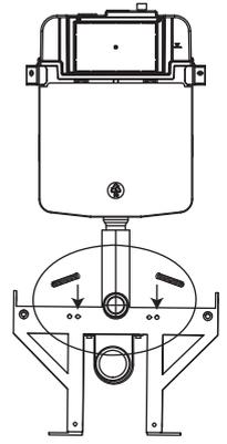
Ajustar el soporte de montaje del desagüe y los espárragos para instalación de la taza.
